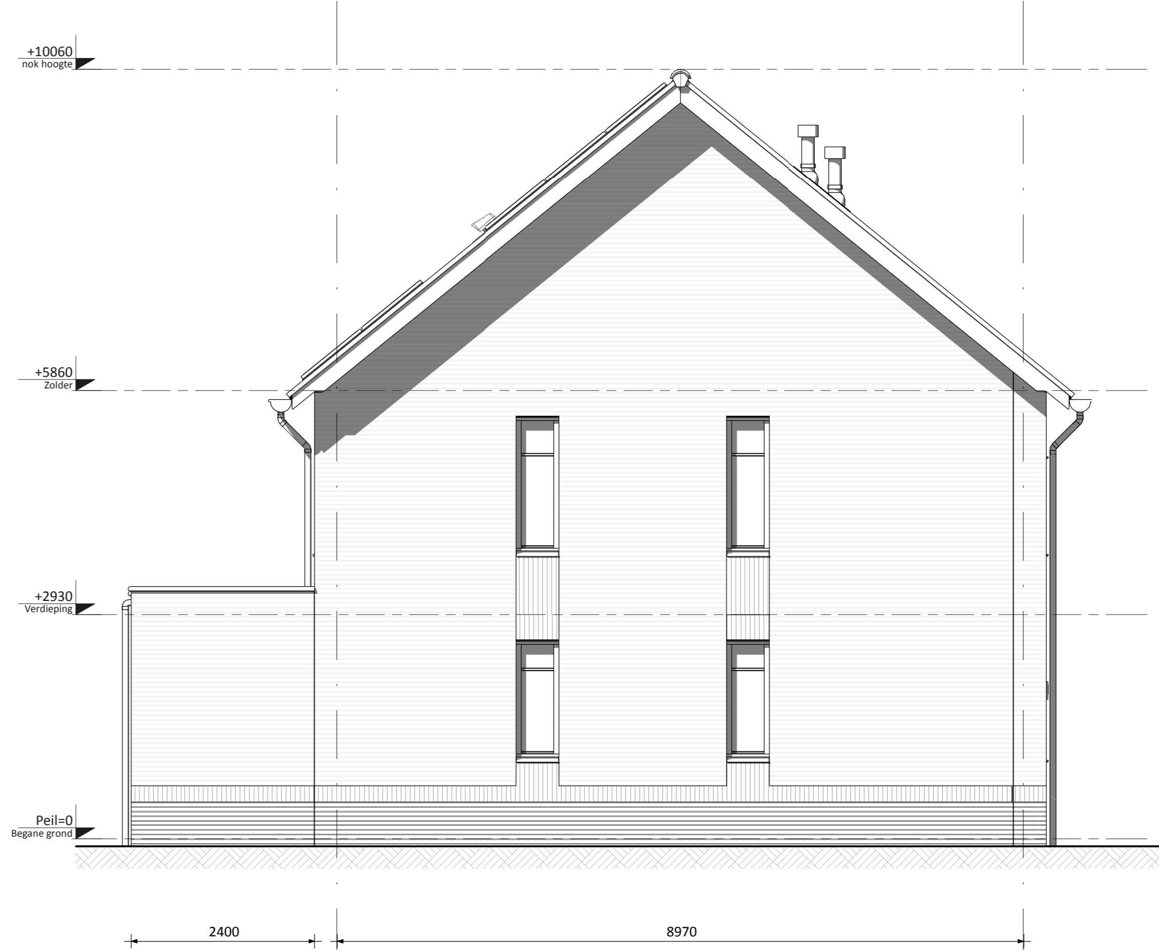
B Linker zijgevel (Bouwnummer 15 heeft geen kozijnen in de zijgevel)
